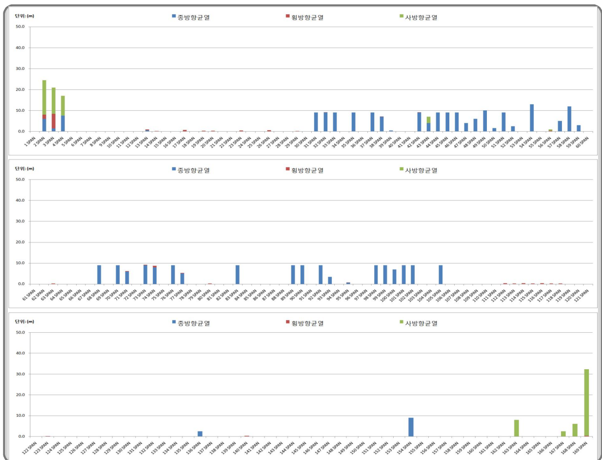
〈그림 3.3〉 본선 콘크리트 라이닝(부산) 유형별 균열 분포현황
